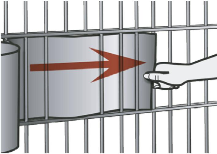
Zaunblendenstreifen werden einfach in die Maschen des Gittermattenzauns eingeflochten. Die Streifen von 19 cm Höhe passen üblicherweise in die Gittermattenzäune mit einem Stababstand von ca. 20 cm.
