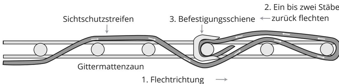
Ist eine Gitterreihe fertig, wird der Zaunblendenstreifen ein oder zwei Stäbe zurückgeflochten. Dadurch können Temperatur-Spannungen ausgeglichen werden.
